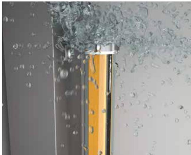
**ECOLAB** Prove di resistenza del materiale alle procedure di pulizia e sanificazione dell'industria alimentare e delle bevande.
