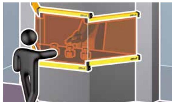
Esempio di collegamento in serie tra una barriera Master e due barriere Slave per la protezione di 3 lati della macchina.
