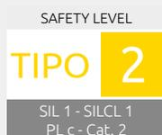
L'unità di controllo AU SX, abbinata alle fotocellule di sicurezza delle serie Ilion o Ulisse, costituisce un sistema optoelettronico di sicurezza di Tipo 2, che può comprendere da 1 a 4 fotocellule.
