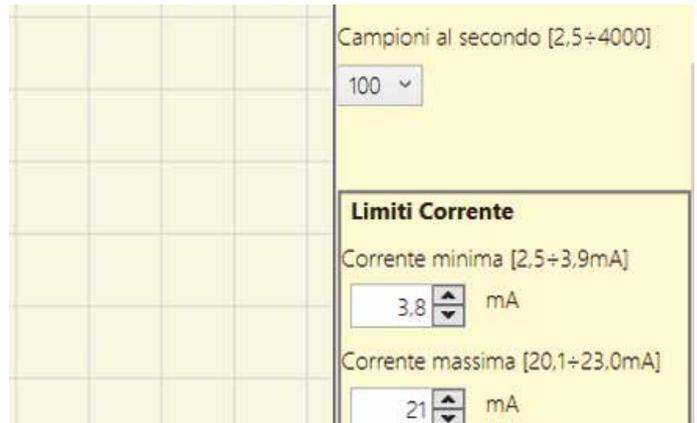
Configurazione del campionamento segnale analogico
