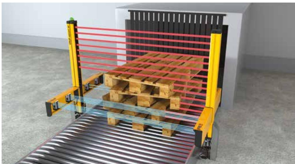
Applicazione con combinazione di Safegate e staffe di Muting MZ con sensori multiraggio M<sup>5</sup> su pallettizzatore con transito di pallet irregolari.
