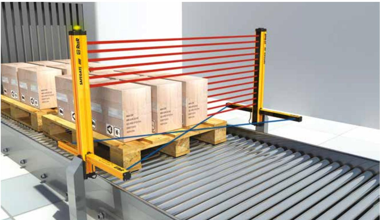
Applicazione con combinazione di Safegate e braccetti di Muting MA su pallettizzatore con transito di pallet regolari
