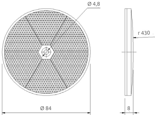
Montaggio: tramite viteria (non fornita)
