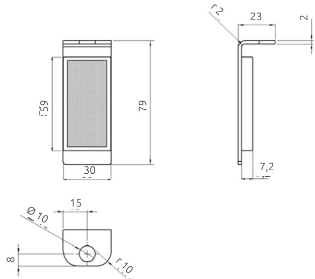
Montaggio: tramite staffa di supporto posteriore (fornita)
