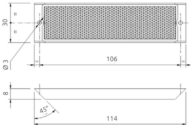
Montaggio: tramite viteria (non fornita)
