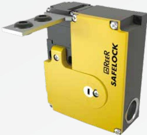
L'interruttore di sicurezza Safelock viene utilizzato nella protezione del personale monitorando ed interrompendo il circuito di sicurezza durante situazioni di pericolo. Il solenoide blocca o sblocca l'accesso alla zona pericolosa garantendo la sicurezza fino alla fine del potenziale pericolo.
