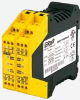
L'unità di controllo AU SXM con funzione di Muting integrata, abbinata alle fotocellule di sicurezza delle serie Ilion o Ulisse, costituisce un sistema optoelettronico di sicurezza di Tipo 2, che può comprendere da 1 a 4 fotocellule.
